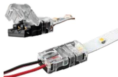
Einführen der isolierten Anschlussleitung (0,34-0,75 mm<sup>2</sup>)\* unter Beachtung der Polarität in die „lange“ Push Einspeiser Seite, so dass die Ader über der V-Schneide liegt.. Verschließen der „langen“ Push Einspeiser Seite (z.B. mit Hilfe einer Kombizange) bis beide Fixpunkte arretieren.
