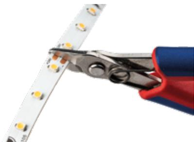
Einfaches Kürzen auf gewünschte Länge an den gekennzeichneten Stellen der LED-Strips.
