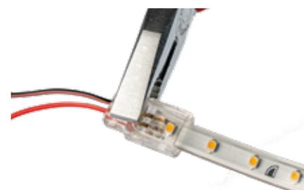
Verschließen der „verjüngten“ Push-Einspeiser-Seite (z.B. mit Hilfe einer Kombizange) bis beide Fixpunkte arretieren.
