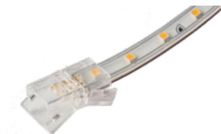
Einführen des LED-Strips in die „breite“ Push-Einspeiser-Seite, sodass die Lötkontakte unter den Kontaktflächen liegen und der bewegliche Verschlussdeckel auf der Unterseite liegt.
