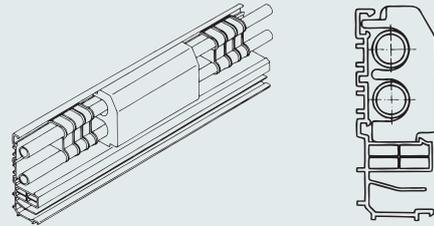
Gerätetankisolierung im Kanalunterteil einlegen (bei Vorlauftemperatur über 70 °C muss die Hartschaumvariante Art.-Nr. 6132175 verwendet werden!).
