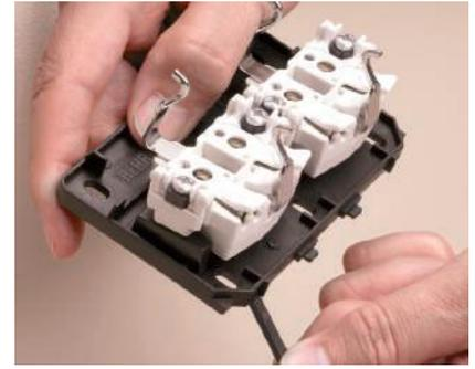
Geräteträger direkt auf das Unterteil setzen. Beim Einsatz des SL-Kanals der Kanalhöhe 70 mm, die beiden Stege (Abstandshalter) abbrechen.
