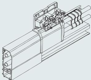
Leitungen getrennt in die Klammern legen und Steckdose bzw. sonstige Anschlussgeräte anschließen. Beide Kanalkammern (Elektro- und Heizungskammer) mit der gemeinsamen Abdeckung verschließen. Die Kanaloberteile stoßen rechts und links in die Nuten der Potenzialtrennplatte.
