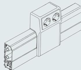
Gerätetank mit Oberteil am Boden eingehängen und mit Blende verschließen.
