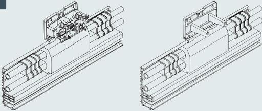
Gerätetank (mittig zur Isolierung) setzen. Anschließend die Bohrlöcher anzeichnen, bohren und den Geräteträger festschrauben.
