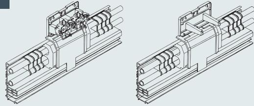
Potenzialtrennplatte ins Kanalunterteil einrasten. Die Isolierung muss links und rechts gleichmäßig überstehen.
